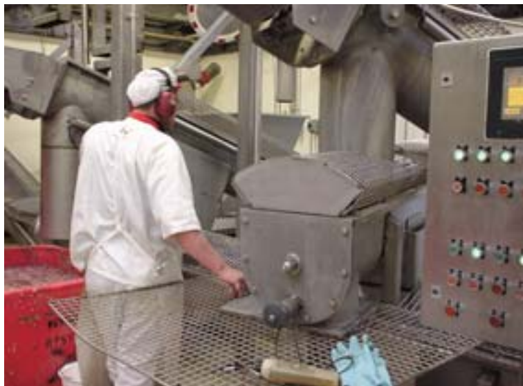
Un employé devant des transporteurs à vis recouverts par un grillage pour prévenir les accidents.
