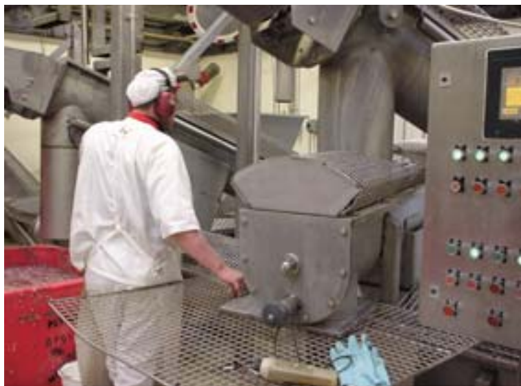
Arbeiter an der Förderschnecke, die zwecks Unfallverhütung mit einem Drahtnetz abgedeckt ist. Medarbejder ved sneglene, som er dækket med net for at forebygge ulykker.
